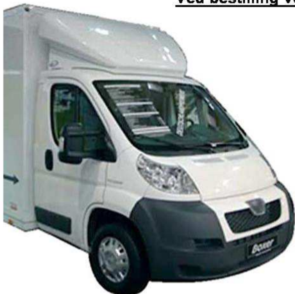
61 1810 Spoiler i hvid glasfiber limbar og justerbar, højde 450/650 mm.
