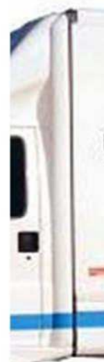
61 1915 Sidevinger i hvid glasfiber limbar, højde 550 mm.
